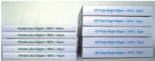
*216-seitige Minibroschüren – links gestrichene Pharmaqualität mit 88 % Opazität, rechts ungestrichene Pharmaqualität mit 87 % Opazität (Quelle: T.S.P. Germany GmbH).*
