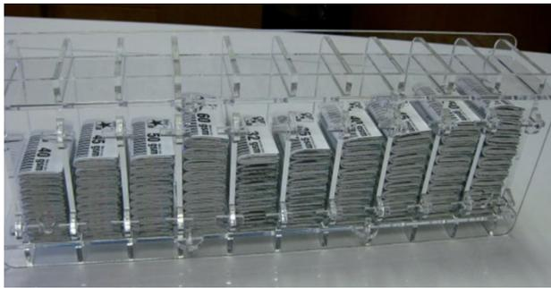
*Höhenvergleich von gefalteten Packungsbeilagen gleicher Formatgröße, aber unterschiedlicher Grammaturen von 35 bis 60 g/m<sup>2</sup> (Quelle: T.S.P. Germany GmbH).*
